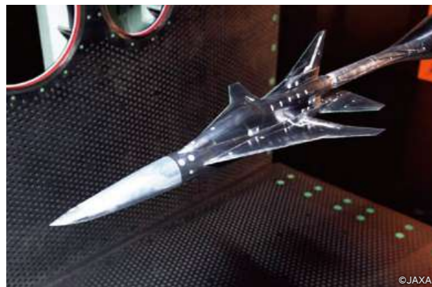
静粛超音速研究機 基本全機遷音速風洞試験
